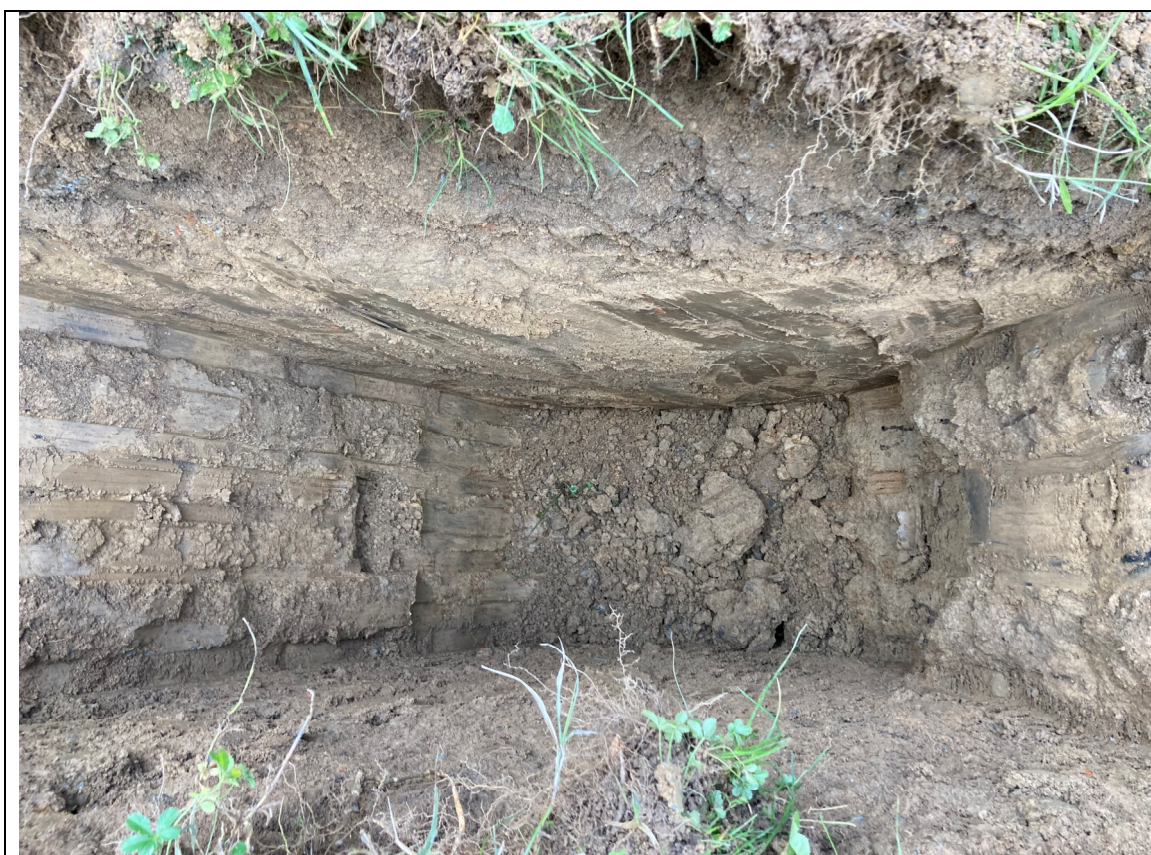
Foto n. 1 – Pozzetto esplorativo escavato nell'ambito del sito di indagine . Si osservano i depositi pseudocoerenti della coltre superficiale e sul fondo compaiono i primi livelli ghiaiosi .
